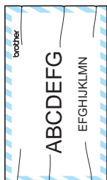
Складки на конвертах
