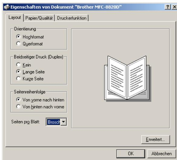
Das MFC/DCP skaliert, formatiert und druckt dann die Seiten vollautomatisch in der richtigen Reihenfolge auf der Vor- und Rückseite des Papiers aus.
